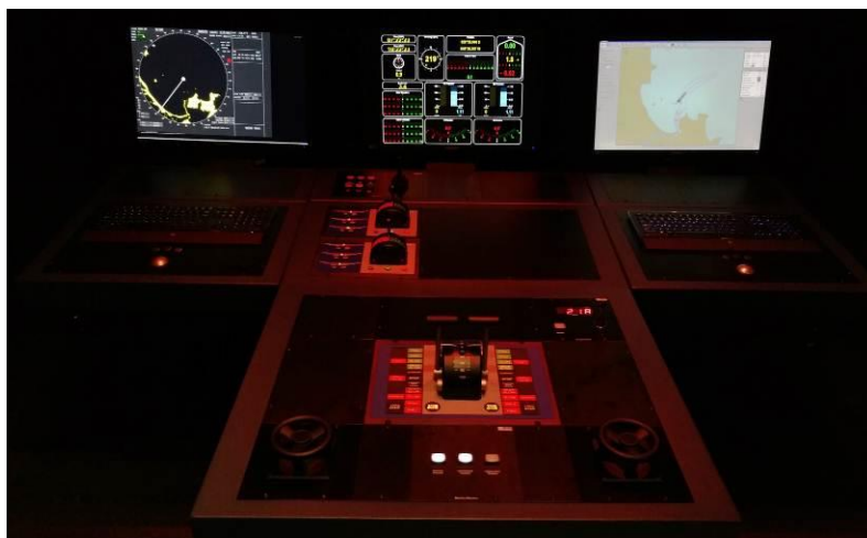
Figura 4. Consoles equipados com instrumentos reais de um navio e monitores de radar, informações da navegação e carta náutica eletrônica respectivamente.
